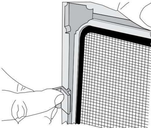
**2** Forare gli stipiti del vano finestra, posizionare i tasselli o fissare con le viti.
