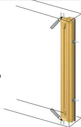
**3** Posizionare il profilo di chiusura laterale, allineato al piano del cassonetto, forare con punta da 4mm a 30cm dagli estremi del profilo, togliere il profilo, allargare i fori con punta da 6mm, posizionare i tasselli, inserire i ferma guida in alto e in basso nel profilo di chiusura, riposizionarlo e bloccare con le viti.
