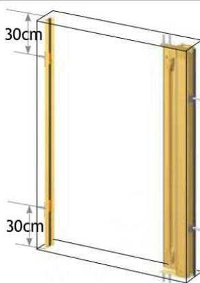
**4** Inserire le guide negli inviti delle testate sul cassonetto e bloccarle con i fermaguida sul profilo di chiusura con viti 3,5x9,5.
