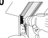
Fissare con la vite in dotazione il fermaguida superiore
