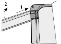
Successivamente inserire l'altra estremità della guida superiore nel profilo di chisura, bloccarla e fissarla con i fermaguida.
