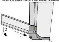
Successivamente nel profilo di chiusura, bloccare la guida con i fermaguida.
