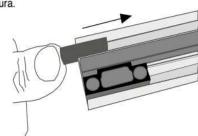
Posizionare il profilo di chiusura nel vano opposto al cassonetto, effettuare tre fori di fissaggio (superiore, centrale e inferiore) e fissarlo.
