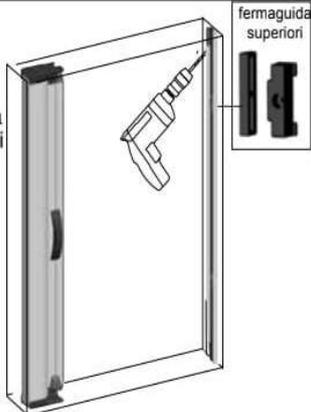
**5** Prima di inserire la guida inferiore, sistemare l'invito guida bassa stondata sulla guida
