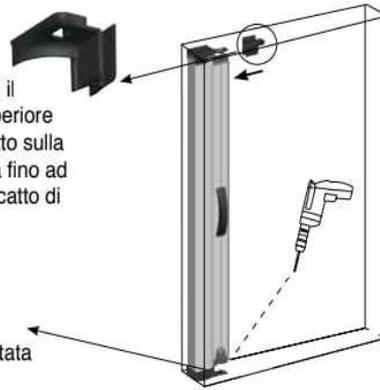
**4** Inserire nel profilo di chiusura il fermaguida, avendo preventivamente controllato la polarità del magnete e quindi definito la posizione dell'alto e del basso. Posizionare il profilo di chiusura sullo stipite opposto al corpo zanzariera. Forare e fissare con le viti e i tasselli in dotazione
