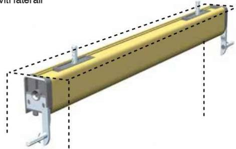
**3** Inserire le guide laterali sotto il cassonetto, negli inviti delle testate, forare con punta da 4mm sulle guide a distanza di 10cm dagli estremi, sfilare le guide, allargare i fori sugli stipiti del vano con punta da 6mm, inserire i tasselli, infilare nuovamente le guide e fissarle con le viti nei fori preventivamente eseguiti.
