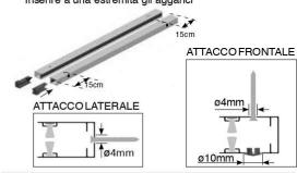
Posizionare il prodotto così montato a sormonto del vano, forare in direzione dei fori delle guide, bloccare con le viti e chiudere con i tappi chiudiforo
