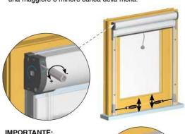
IMPORTANTE: per poter far funzionare correttamente il prodotto dopo la regolazione inserire necessariamente il tappino di blocco nella testata.
